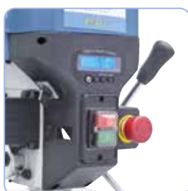
Visualizzatore della profondità di foratura digitale per un lavoro comodo
