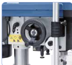
Volantino posizionato lateralmente per impostare la velocità desiderata
