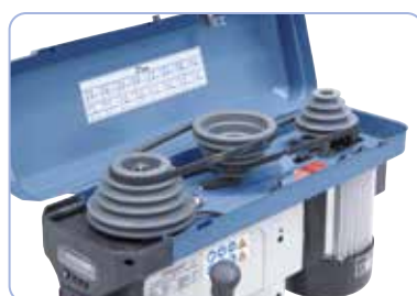
Massima silenziosità grazie alle pulegge bilanciate
