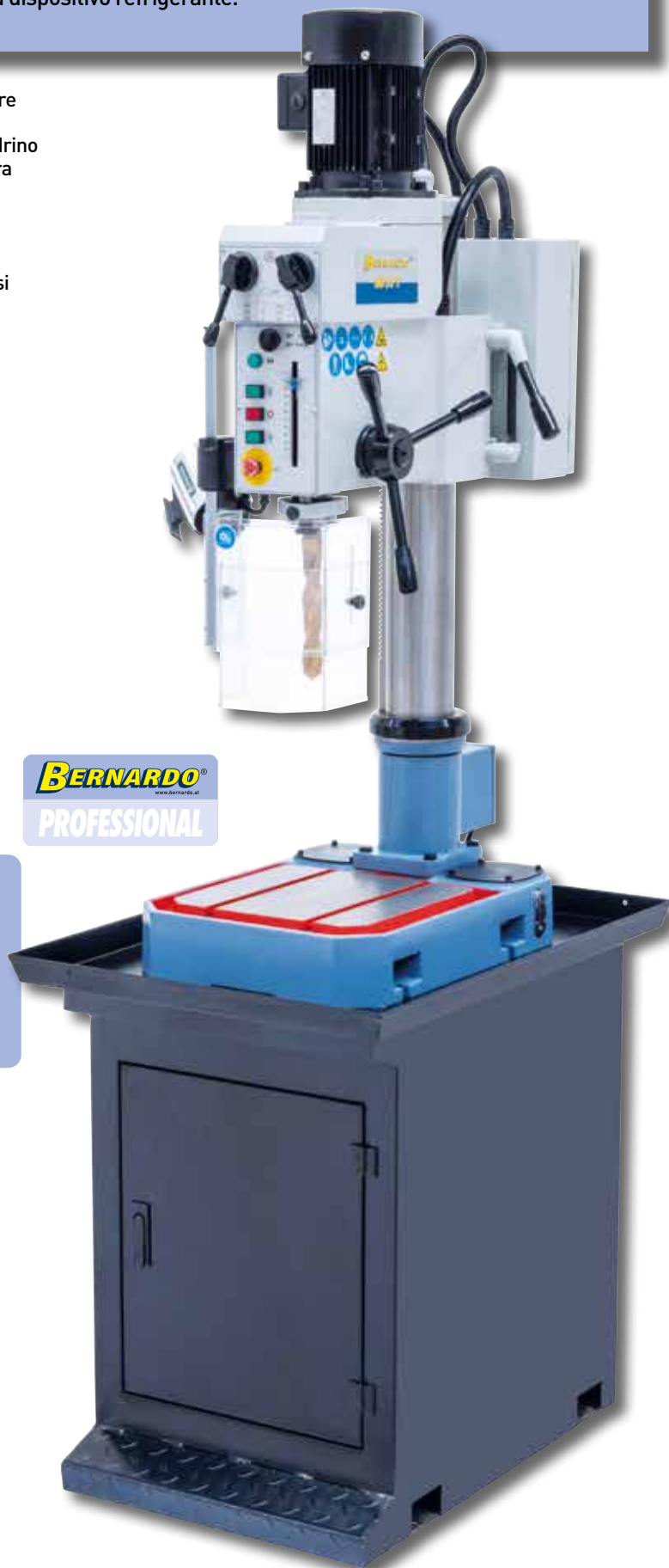
Grande e massiccio piano da lavoro con scanalature a T. L'immagine mostra il GB 30 T con dispositivo refrigerante
