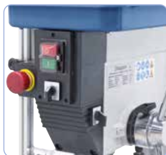
Puls. emerg., interr. senso rotaz. e interr. 2 pos. sul lato ant. macchina
