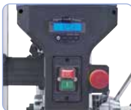
Visualizzatore della profondità di foratura digitale per un lavoro comodo
