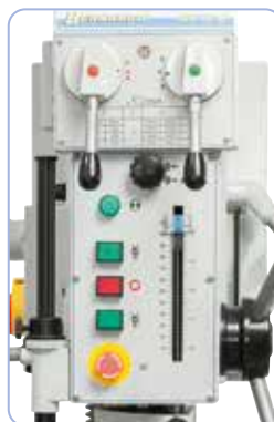
Elementi di commutazione e funzionali disposti in maniera intuitiva sul lato anteriore della macchina
