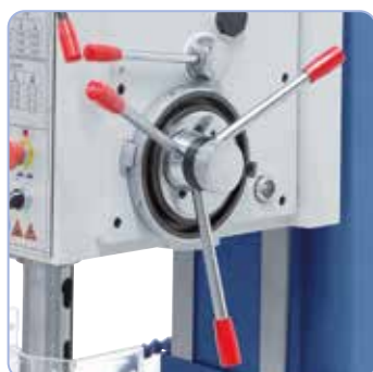
Manopola a stella per l'alimentazione manuale del mandrino, leva della frizione per l'alimentazione automatica
