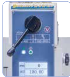
La grande tavola di foratura può essere inclinata da -45° a +45°
