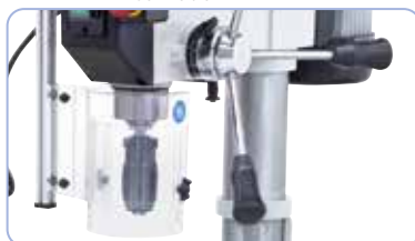
In dotazione: mandrino per trapano a serraggio rapido 1 - 16 mm
