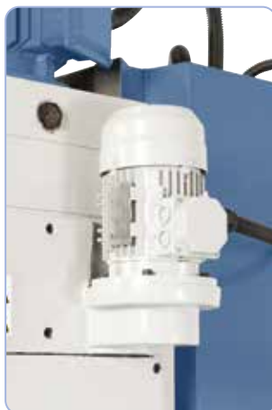
Motore di avanzamento per la riduzione dei tempi di posizionamento del mandrino (a KBM 63)
